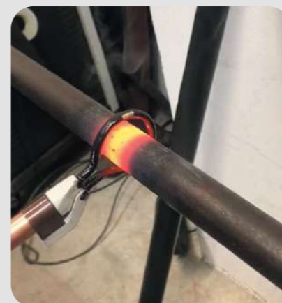
Ohýbání ocelové trubky Induktor smyčky S180/D20
