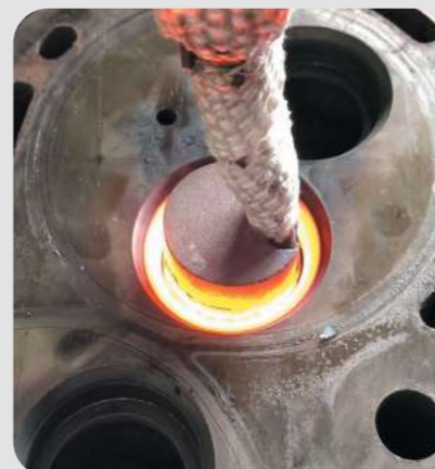
Ohřev sedla ventilu Indukční smyčka Heat Tube S180/D40 Šířka Ø 40
