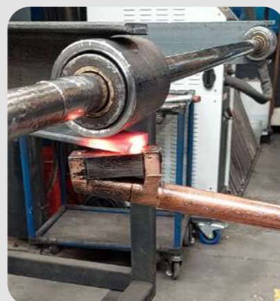
Výroba rámu přívěsu před svařováním Induktor Large L70 Powerduction 220LG
