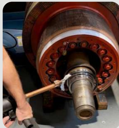
Vyjmutí kroužků z elektrického motoru Indukční smyčka L20/D200 Powerduction 220LG
