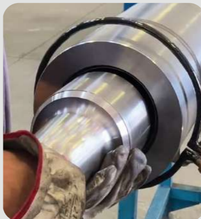
Smršťování válce pro hydraulické písty Indukční smyčka L20/D200 Powerduction 220LG
