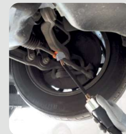
Uvolnění řízení spojovacích tyčí Induktor Small S20/B1
