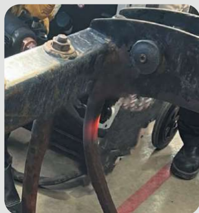
Narovnání zubů lžic Induktor Large L20B4 Powerduction 220LG
