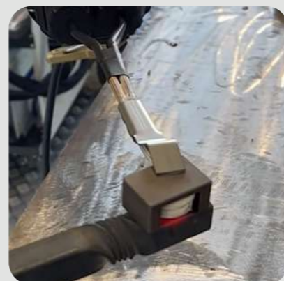
Ohřev ocelových tyčí: Induktor 10R/B5 - Powerduction 10R
