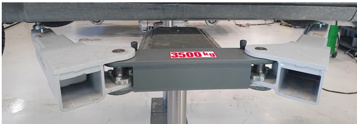
SPACE SDI 110 NK - 2 pístové zvedáky s výsuvnými rameny, nosnost 3500 kg - 2 ks
