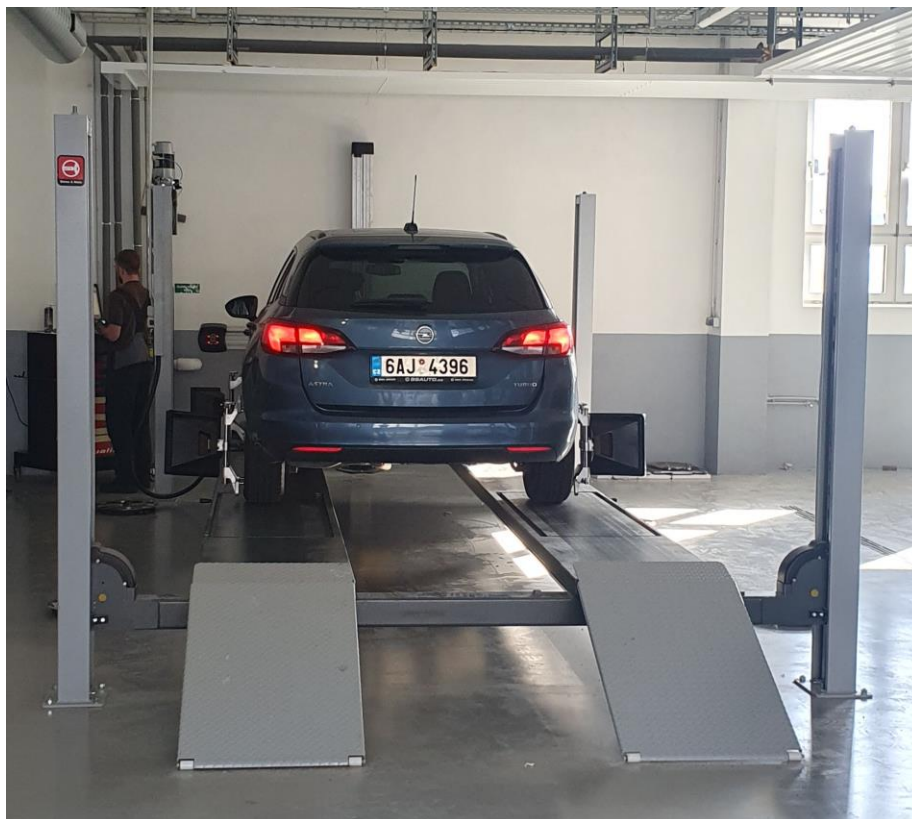
SPACE SQ 502 L - 4 sloupový hydraulický zvedák 5000 kg pro 3D geometrii
