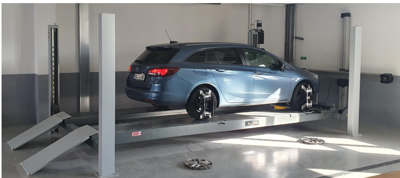
SPACE SQ 502 L - 4 sloupový hydraulický zvedák 5000 kg pro 3D geometrii
