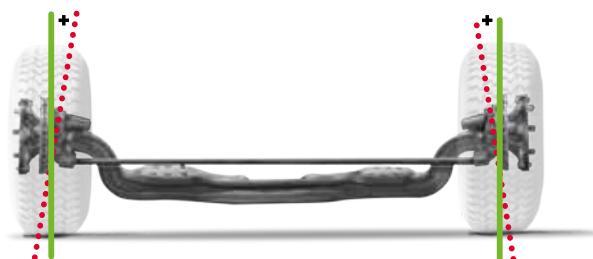
Příklon rejdového čepu
